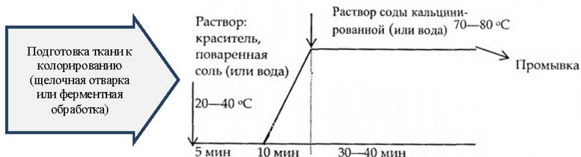
Рисунок 1 – Схема подготовки и крашения хлопчатобумажных и льняных тканей периодическим способом
