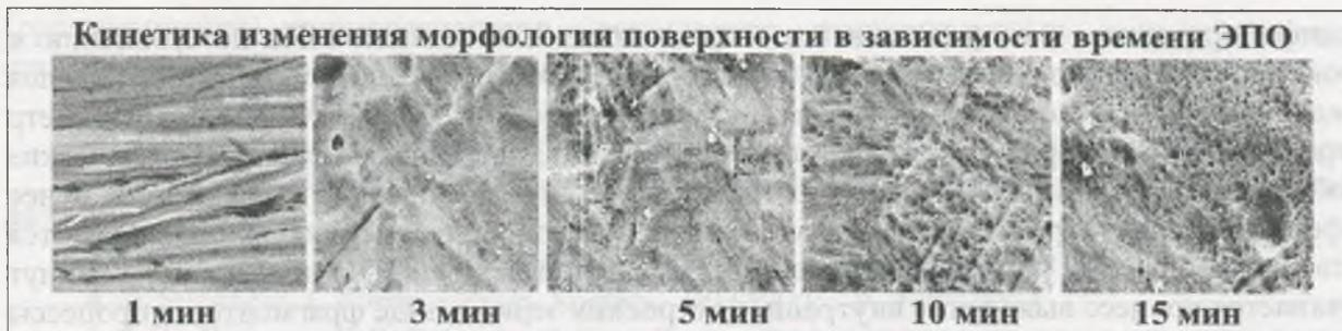
Рисунок 1 – Формирование структуры поверхностного модифицированного слоя аустенитной нержавеющей стали с повышенной коррозионной стойкостью на оптимальных режимах ЭПО.
