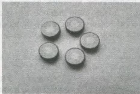
Рисунок 2 – Терморезисторы с двухслойными контактами.
