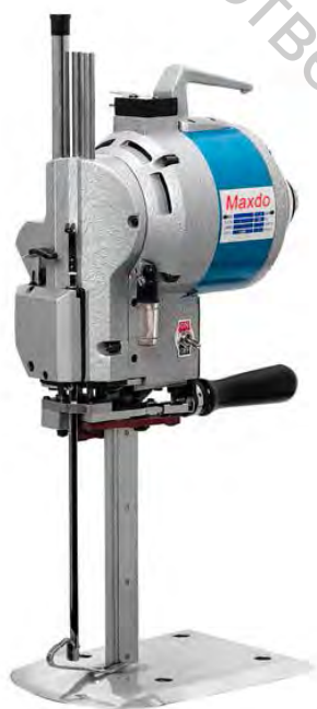
Рисунок 4.12 – Передвижная раскройная машина с возвратно-поступательным движением ножа (прямой нож)
