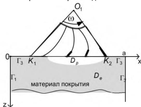
Рисунок 6 – Условная схема съема материала;  $D_e$  – область упругой деформации;  $D_p$  – пластическая
