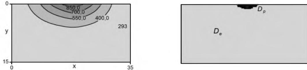
Рисунок 16 – Распределение температуры в доноре и участки упругой и пластической области в момент времени  $t=0.05\text{с}$
