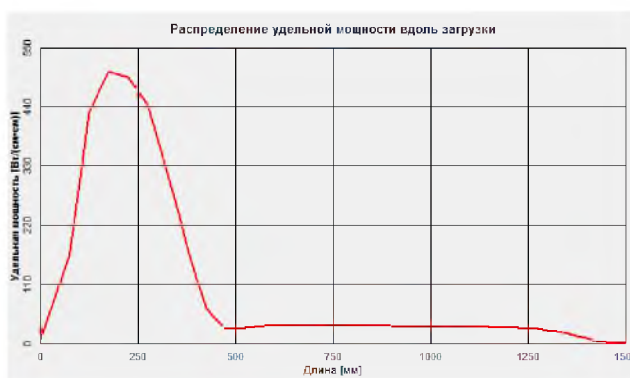
Рисунок 23 – Распределение удельной мощности вдоль загрузки
