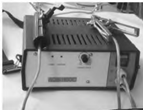
Рисунок 26 – Сварочный аппарат с блоком питания на основе новых высокочастотных композиционных материалов.
