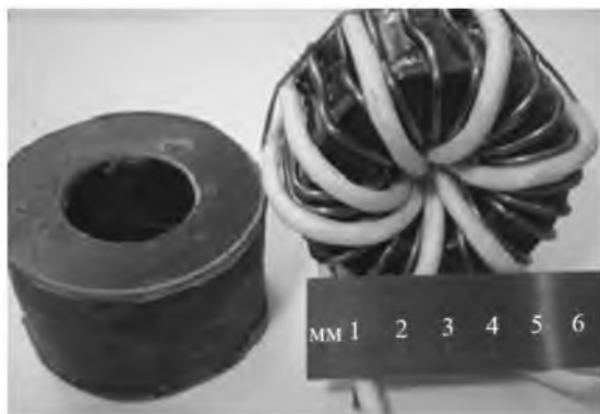
Рисунок 25 – Сердечник для трансформатора диаметром 50мм и высокочастотный трансформатор мощностью 5 кВт на основе композиционного материала
