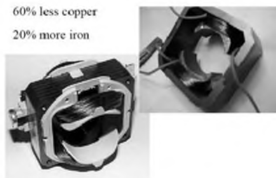
Рисунок 21 – Преимущество двигателей на композиционном материале в сравнении с ламинированным
