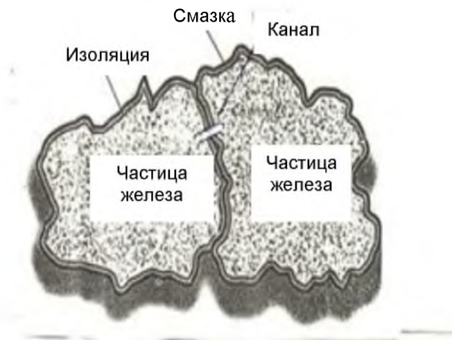
Рисунок 2 – Вид порошков железа в спрессованном состоянии
