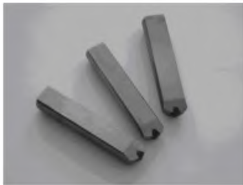
Рисунок 17 – Внешний вид металлообрабатывающего инструмента с пластинами из сверхтвердого КМ, закрепленными к державкам методом пайки
