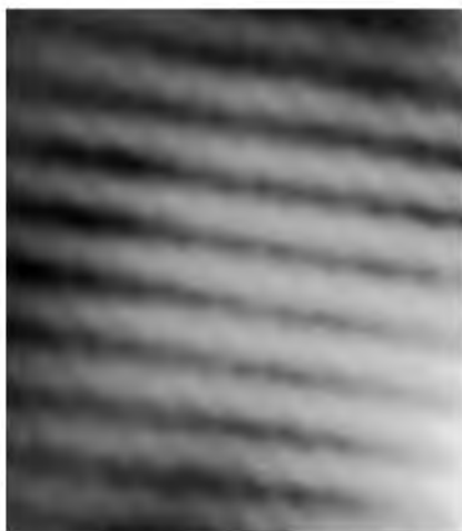
Рисунок 27 – Дифракционная картина на периодическом распределении наночастиц никеля размерами 60 нм в водной суспензии под действием зеленого лазера с длиной волны 532 нм и плотностью мощности 0,0003 \text{ Вт/см}^2 (период структуры – 25 микрон)
