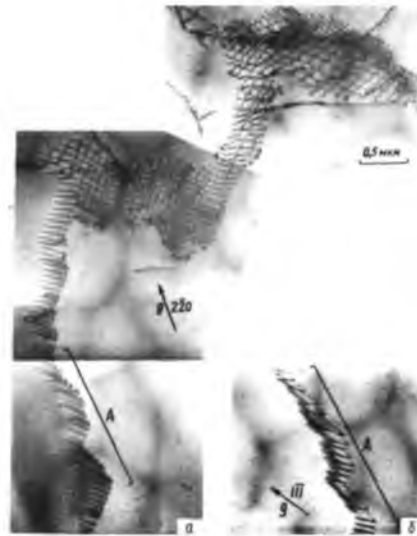
Рисунок 4 – Межблочная граница из чередующихся гексагональных и 4-угольных сеток и стенок дислокаций в германии
