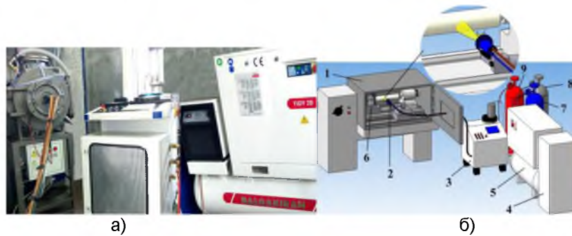
Рисунок 2 – Общий вид (а) и схема (б) технологического комплекса для формирования наноструктурированных поверхностных слоев из материала с ЭПФ
