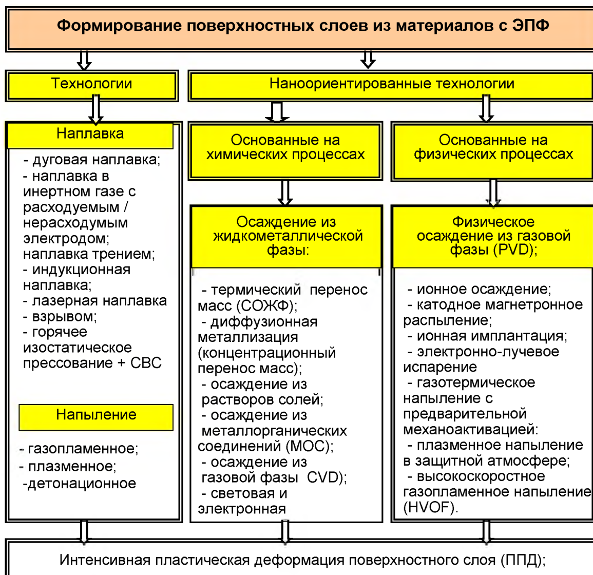
Рисунок 1 – Основные технологии формирования поверхностных слоев из материалов с ЭПФ
