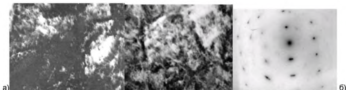
а) – \times 60000 ; б) – микроэлектроннограмма Рисунок 19 – Ячеистая структура в стали 40 после воздействия потока микрочастиц SiC (фракции 50-60 мкм)
