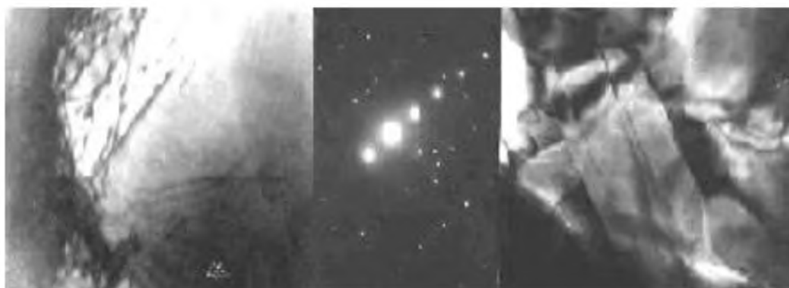
а) - формирование дислокационного ансамбля на границе зерна; \times 60000 б – микроэлектроннограмма; в – микродвойники в теле зерна; \times 60000 Рисунок 17 – Микроструктура стали 40 после воздействия потока микрочастиц SiC (фракции 50-60 мкм)
