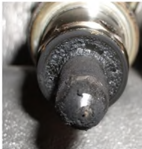
Рисунок 2 – Нагар, образующийся на распылителях форсунок
