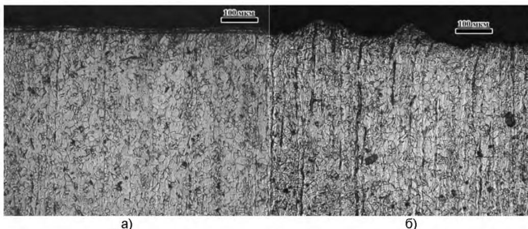
Рисунок 12 – Фрагменты образцов с участками фронтальной поверхности после ЭПО и удара со скоростью V_0=345 м/с (а) и V_0=391 м/с (б)
