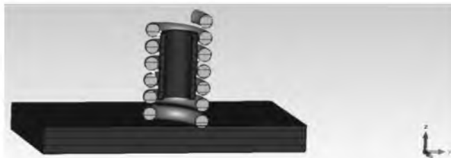
Рисунок 4 – Заготовка в спиральном индукторе (сечение вертикальной плоскостью, проходящей через ось)
