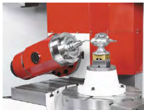
Рисунок 3.16 – Рабочие зоны 5-координатных станков с парой B+C
