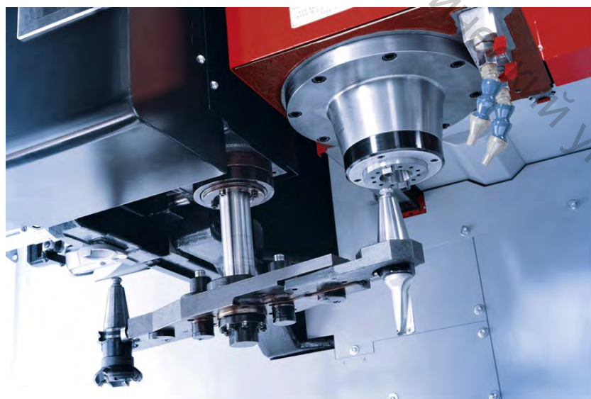
Рисунок 3.12 – Автооператор с двумя захватами для смены инструмента
