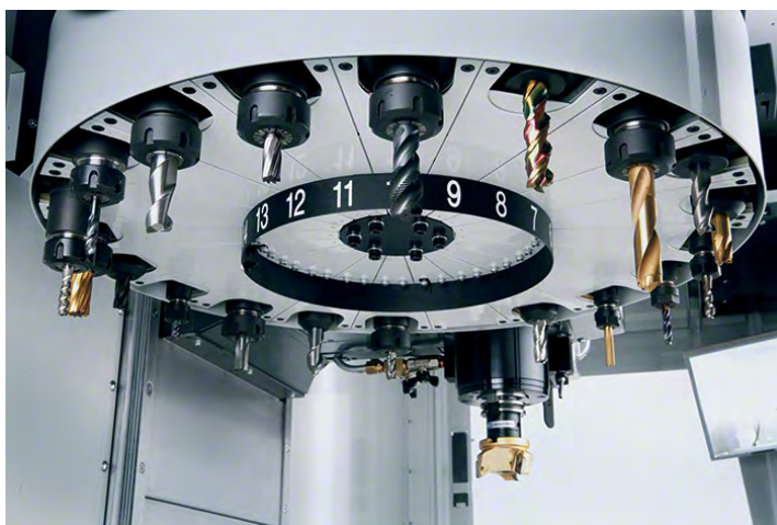
Рисунок 3.9 – Магазины поворотного типа
