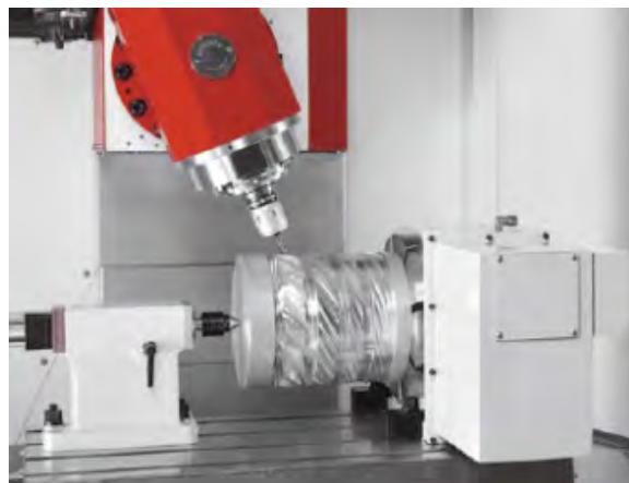
Рисунок 3.15 – Рабочие зоны 5-координатных станков с парой координат A+B
