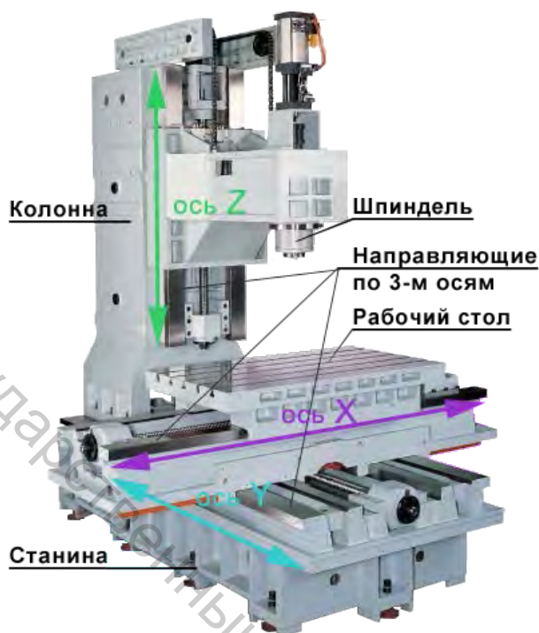
Рисунок 3.13 – Компоновка вертикального ОЦ ФСР группы
