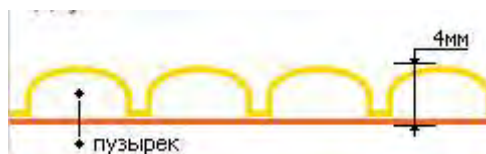
Рисунок 12.6 – Двухслойная воздушно-пузырчатая пленка
