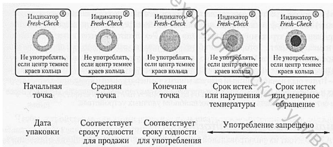
Рисунок 12.11 – Индикатор Fresh-Check компании Lifelines. Примеры стадий изменения
