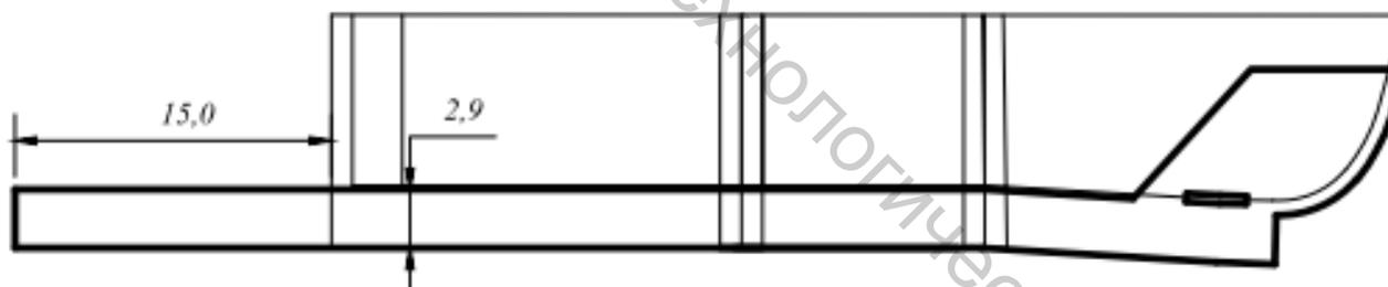
Рисунок 5.4 – Схема построения вспомогательного лекала для намелки линий подгиба низа изделия
