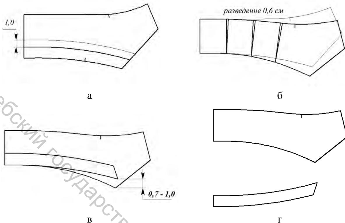
Рисунок 2.3 – Схема построения шаблонов верхнего воротника и стойки
