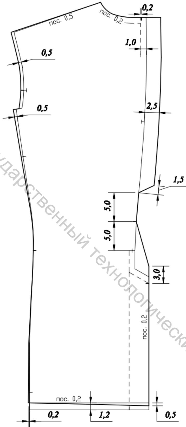
Рисунок 3.2 – Схема построения чертежа лекала детали спинки мужского пиджака из подкладочной ткани (вариант № 1)
