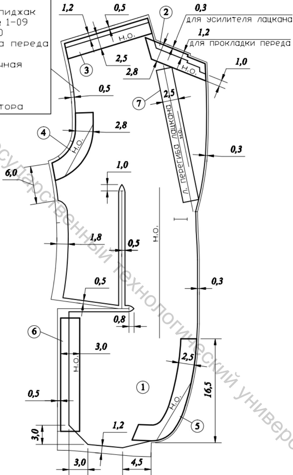
Рисунок 4.1 – Схема построения чертежей лекал деталей прокладок переда
