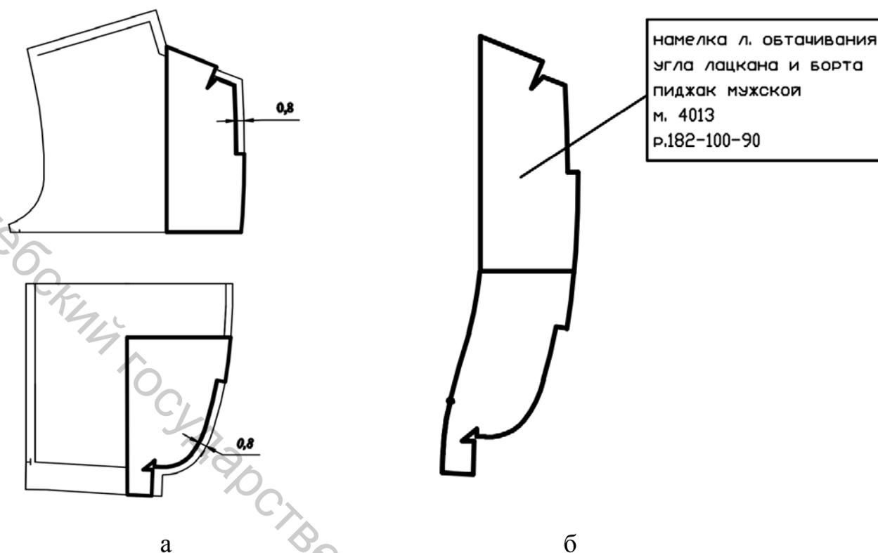
Рисунок 5.3 – Схема построения лекал для намелки линии обтачивания углов лацкана и борта
