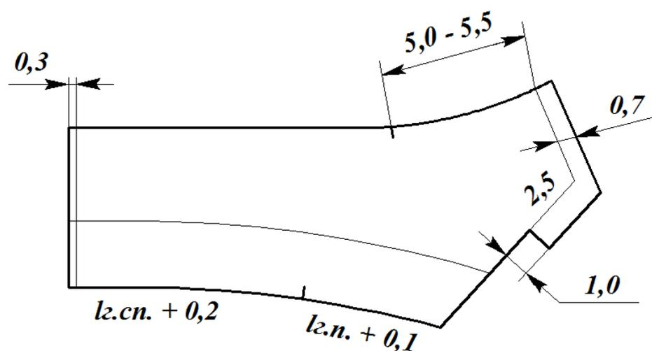
Рисунок 2.2 – Схема построения чертежа лекала нижнего воротника
