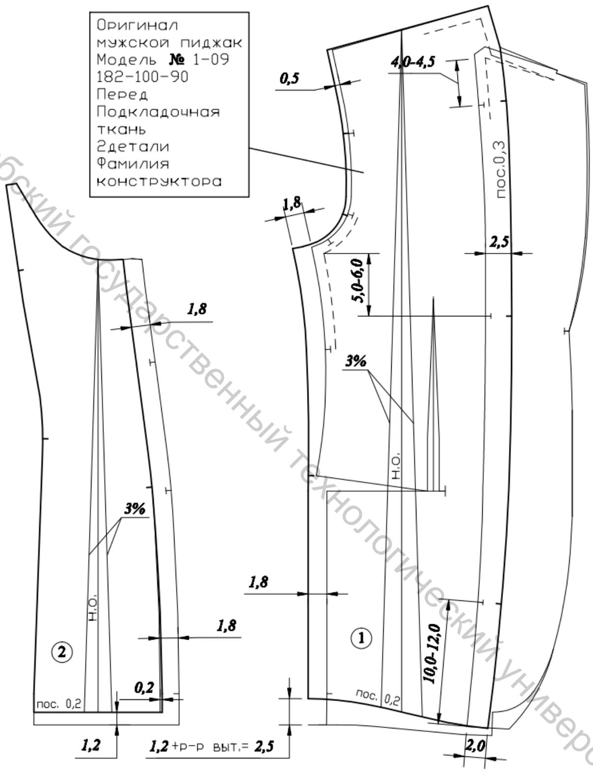
Рисунок 3.4 – Схема построения чертежей лекал деталей переда и бочка мужского пиджака из подкладочной ткани
