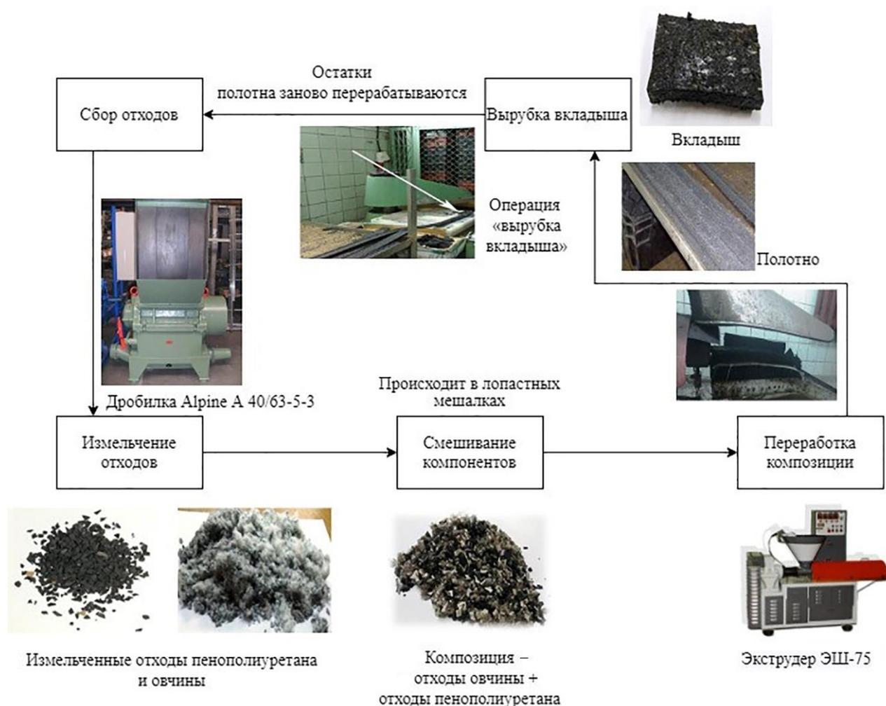
Рисунок 3 – Технология получения вкладыша для низа обуви
