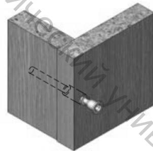
Рисунок 2.8 – Пример соединения стяжкой-евровинт с потайной головкой под шестигранник
