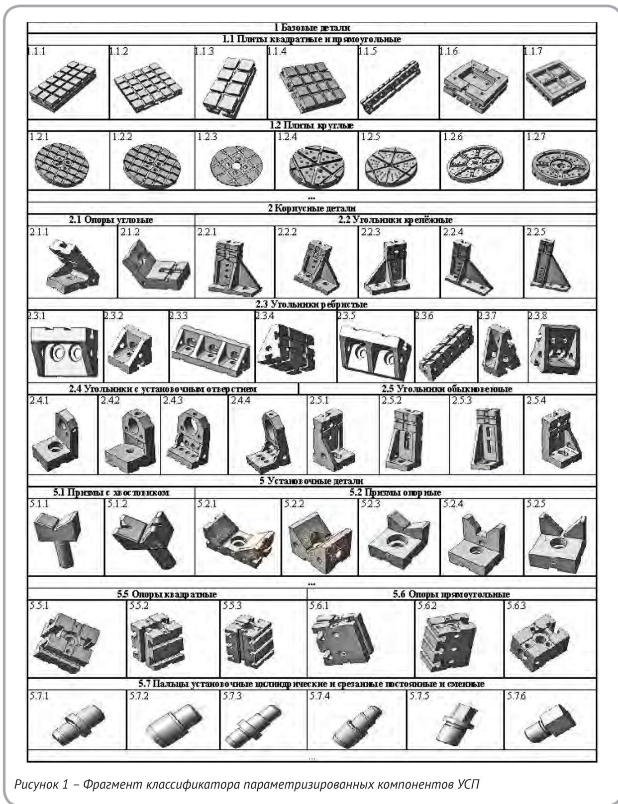
Рисунок 1 – Фрагмент классификатора параметризованных компонентов УСП
