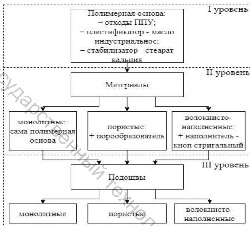
Рисунок 1 – Трехуровневая система получения полимерных материалов и подошв обуви
