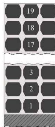
Рисунок 2 – Модель укладки частиц в обмазке
