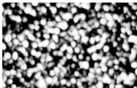
Рисунок 2 – Акустическое изображение строения пьезокерамики ЦТС-19 на глубине ~32 мкм (частота 404 МГц, размер по горизонтали 250 мкм)
