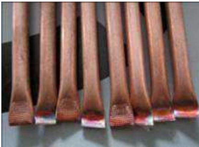
Рисунок 1 – Образцы медных трубок, герметично заваренных ультразвуковой сваркой
