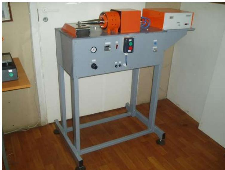
Рисунок 3 – Внешний вид шовной ультразвуковой сварочной машины типа МШУ1-0,1/22
