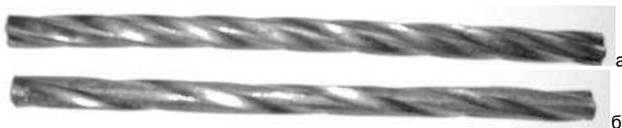
Рисунок 3 – Арматурный профиль (а – пятизаходный; б – трехзаходный)
