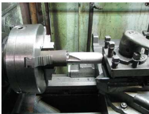
Рисунок 4 – Исследование обрабатываемости покрытий из разработанных износостойких антифрикционных порошковых шихт для определения оптимальных режимов резания
