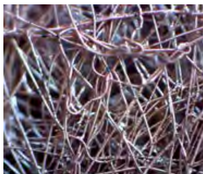
Рисунок 3.5 – Структура иглопробивного нетканого текстильного материала с наноразмерным медным покрытием
