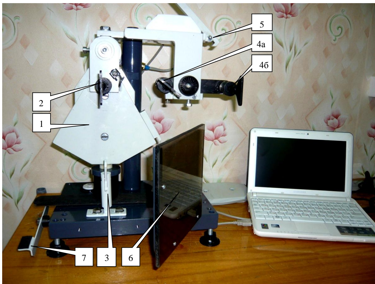
Рисунок 1 – Программно-аппаратный комплекс для определения разрывных характеристик лубяных волокон с применением машины К-1
