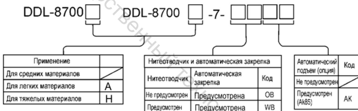
Рисунок 6.1 – Обозначение машин серии DDL-8700
