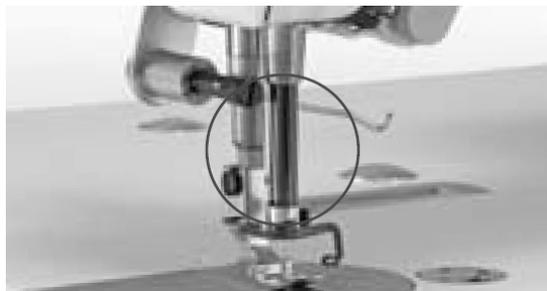
Рисунок 6.40 – Игловодитель с напылением DLC
