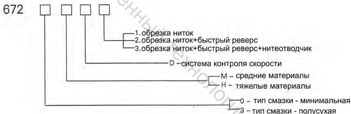
Рисунок 6.34 – Заводская классификация машин серии GC672 фирмы Typical
