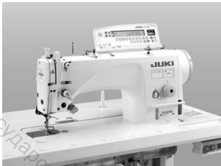
Рисунок 7.1 – Общий вид машины DLN-9010 Juki
