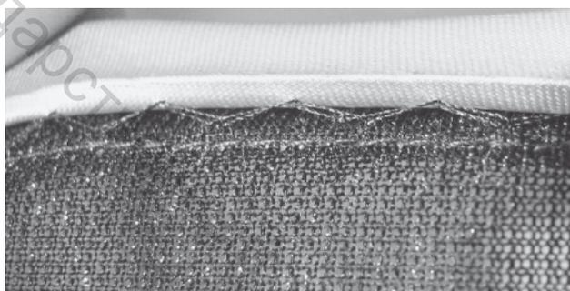
Рисунок 13.4 – Вид шва на машине 3200D Strobel
