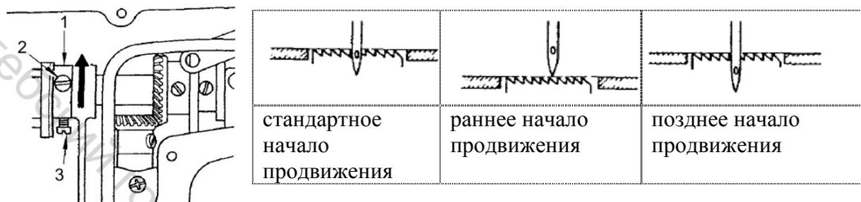
Рисунок 6.21 – Регулировка фазы движения рейки
