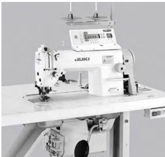
Рисунок 7.11 – Общий вид машины DMN-5420 Juki
