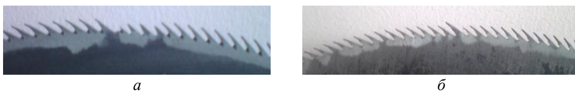
Рисунок 1 – Трансформация зубьев новых джинных пил в зависимости от точности работы делительного механизма пилонасекательного станка СПХ с положительной накопленной погрешностью (а) и с отрицательной накопленной погрешностью (б)
