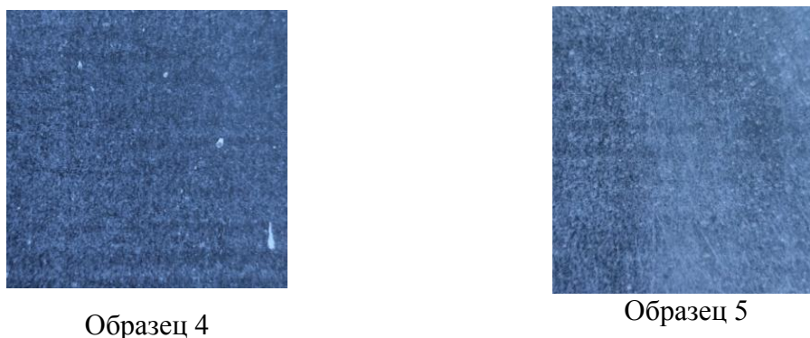
Рисунок 2 – Внешний вид подложки после снятия нановолокнистого покрытия
