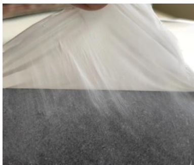
Рисунок 3 – Процесс снятия покрытия с подложки
