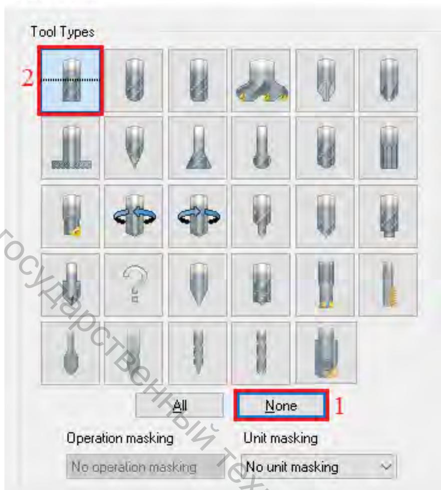
Нажать «OK», после чего выбрать из списка инструмент *FLAT END MILL - 4*.
