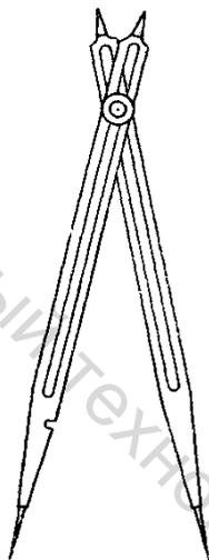
Рисунок 1.10 – Циркуль для пропорционального деления
