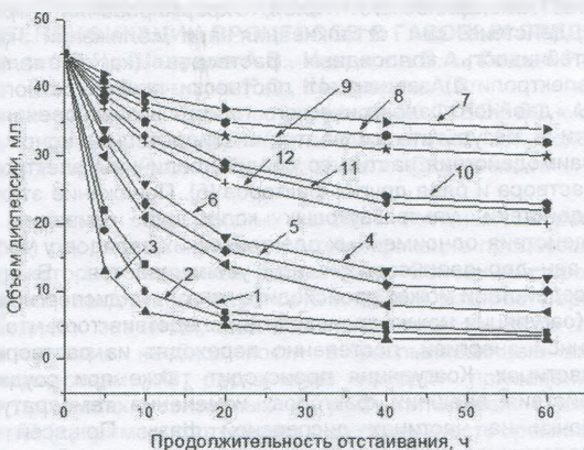
Рисунок 1 – Скорость седиментации наноалмаза в универсальном электролите хромирования для различной концентрации наноалмаза в суспензии при разной продолжительности УЗК-обработки
