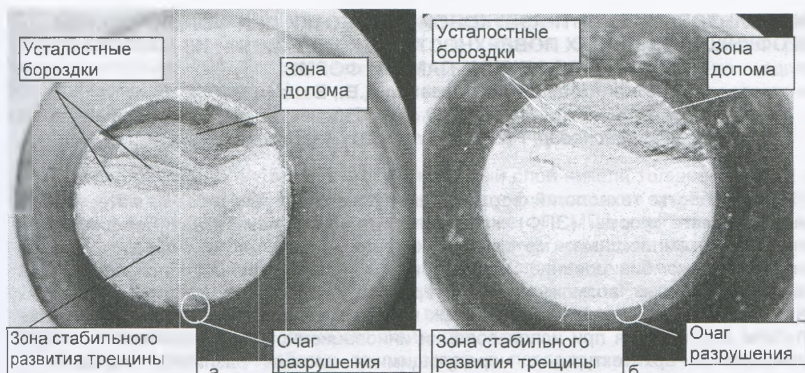
Рисунок 2 – Характер изломов образцов после проведения испытаний (а) – образец с цинковым диффузионным слоем (б) – образец без защитного покрытия
