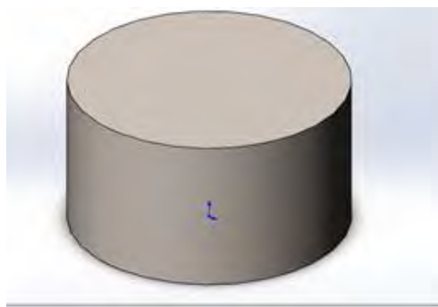
Рисунок 4.1 – Использование инструментов «Автоматическое нанесение размеров» и «Вытянутая бобышка/основание» при создании 3D-модели изделия (детали, входящей в состав сборочной единицы)
