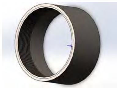
Рисунок 4.2 – Использование инструментов «Вытянутый разрез» и «Условное обозначение резьбы» при создании 3D-модели изделия (детали, входящей в состав сборочной единицы)
