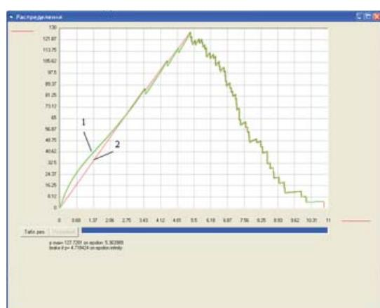
Рисунок 3 – Результаты моделирования разрыва пучка хлопковых волокон
