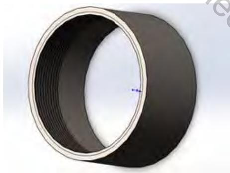
Рисунок 8.2 – Использование инструментов «Вытянутый вырез» и «Условное обозначение резьбы» при создании 3D-модели изделия (детали, входящей в состав сборочной единицы)
