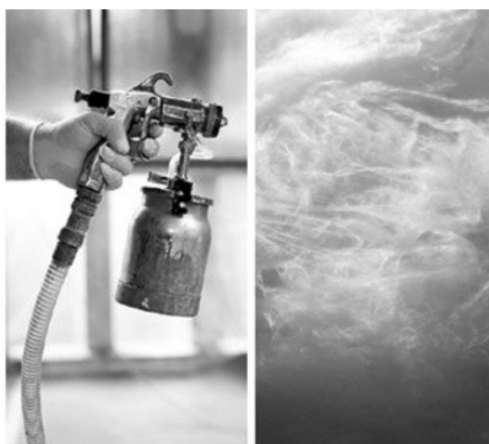
Рисунок 3 – Схема скрепления нетканого материала при использовании технологии распыления утеплителя из аэрозоля
