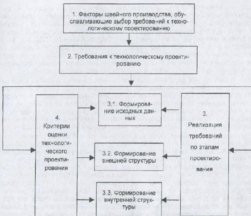
Рисунок 1 – Методология проектирования гибких модульных потоков
