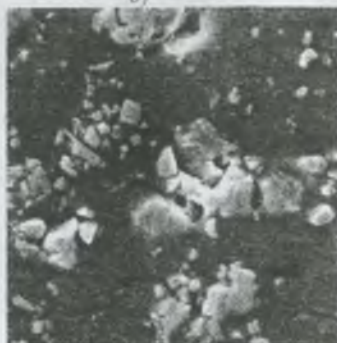
Рис. 2. Микроструктура композиционного ГДН покрытия на основе WC – Si, полученного при режиме «2», на поперечном шлифе. а) x 17; б) x 100; в) x 5000; г) x 10000;
