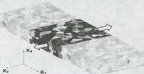
Рис. 1. Модельный поликристалл с периодической структурой, сгенерированный на сетке 200 \times 63 \times 200 , стрелками указано направление растяжения
