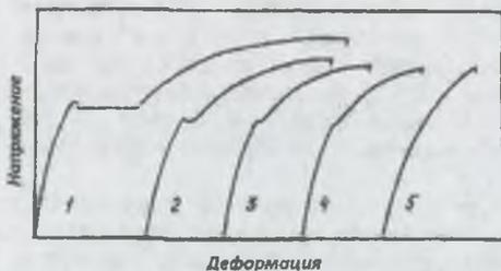
Рис. 1. Кривые деформации железа с различным содержанием водорода: 1 — без водорода; 2 — 12,6 ppm; 3 — 28,1 ppm; 4 — 45,1 ppm; 5 — 60 ppm
