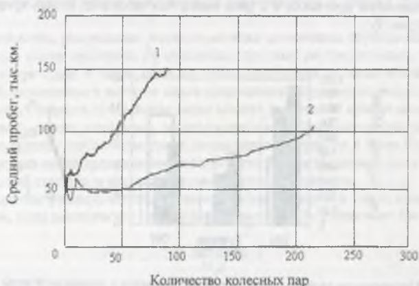
Рис. 2. Средние значения пробега упрочненных 1 и неупрочненных 2 колесных пар
