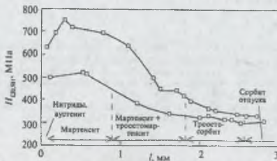
Рис. 1. Распределение микротвердости и микроструктуры по глубине упрочненного слоя в колесной стали
