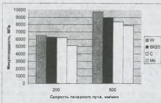
Рис. 1. Диаграмма влияния состава электрода на микротвердость слоев после лазерной обработки
