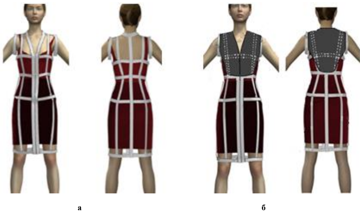
Рисунок 4 – Формозакрепляющие каркасы в меховой одежде: а – ленточный каркас [32], б – ленточный каркас с цельноформованными деталями из войлока на верхнем опорном участке [33]
