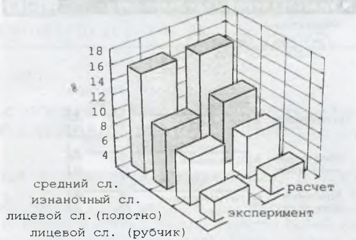
Рисунок 2 - Расчетные и экспериментальные значения уработок нитей основы.
