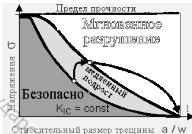
Рисунок 17.5 – Переход к динамическому распространению трещины
