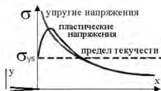
Рисунок 15.2 – Распределение напряжений в вершине трещины
