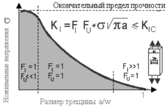
Рисунок 18.4 – Зависимость номинального напряжения от размера трещины
