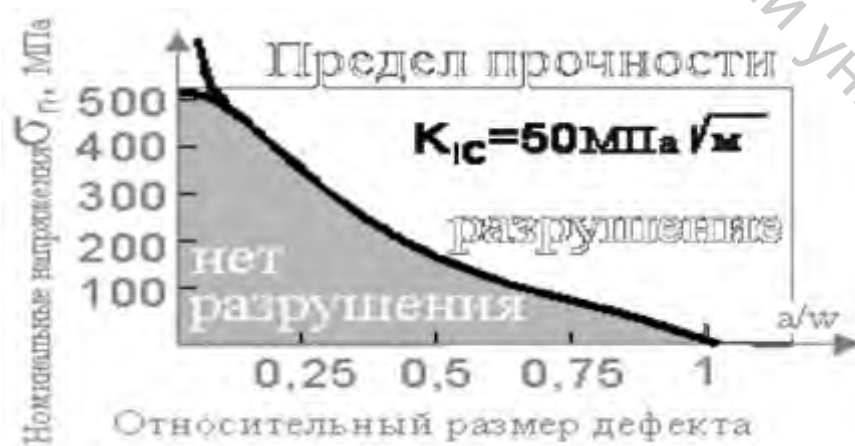
Рисунок 16.3 – Зависимость номинальных напряжений от относительных размеров дефекта
