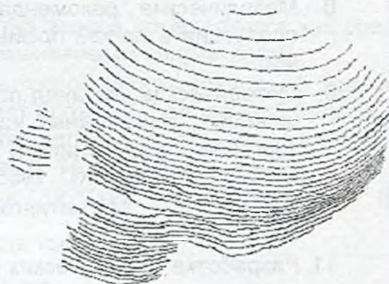
Рисунок 2 - Скелетизированное изображение фрагмента поверхности нерегулярного объекта
