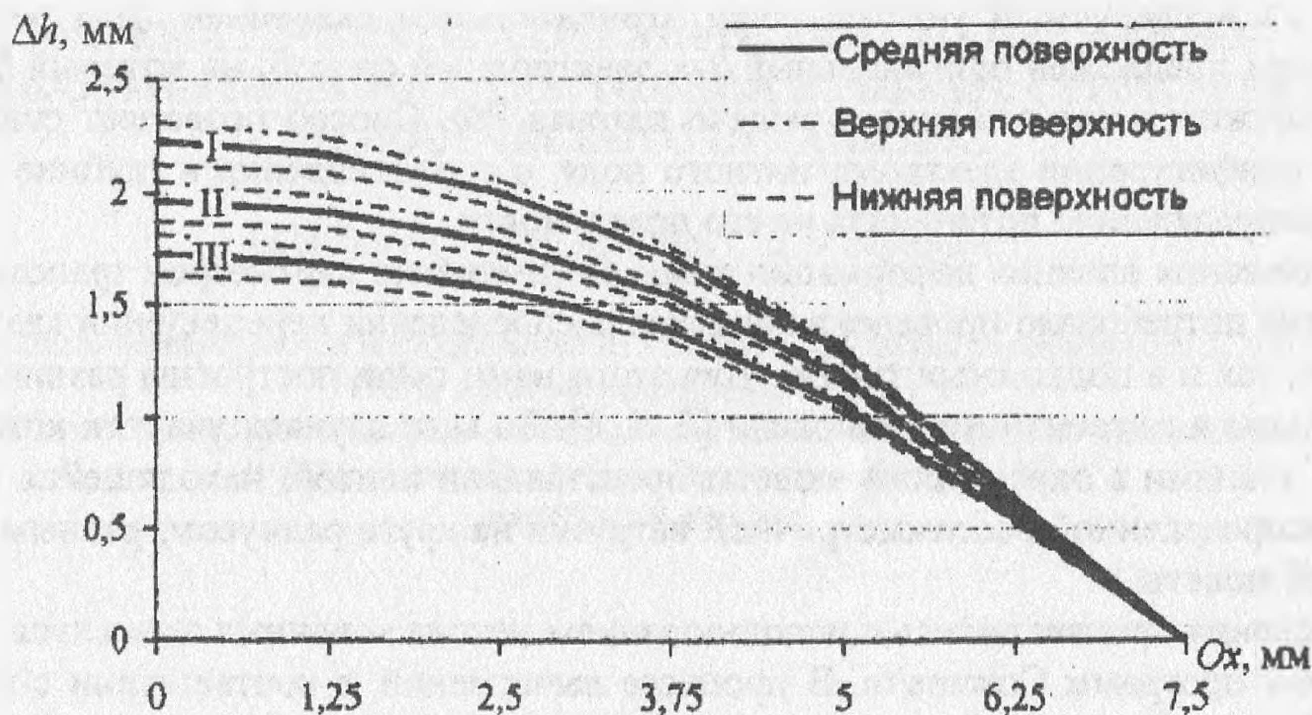
Рис. 2. Распределение вертикальных перемещений \Delta h слоя кожи при различных величинах отрицательного давления. I – 300 мм рт. ст., II – 250 мм рт. ст., III – 200 мм рт. ст.
